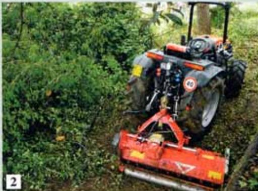
**1**-Operazione di recupero di un terrazzamento invaso dai rovi mediante un decespugliatore dotato di lama apposita. **2**-Nelle infestazioni più estese e nelle zone raggiungibili in sicurezza si possono impiegare attrezzature meccaniche specifiche, ad esempio un trattore dotato di trincia (nella foto)
